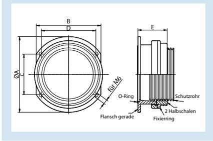
**Kunststoff-Flanschanschluss für NORDUC® XXL Schutzschläuche**
