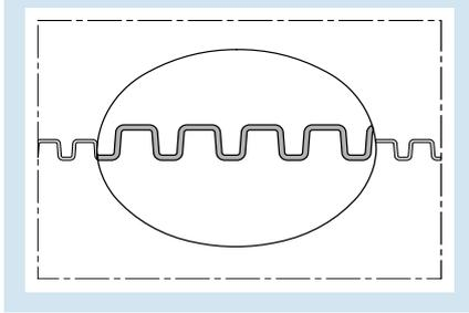
**Extra großer, parallelgewellter Kunststoff-Schutzschlauch/Kabelsammler aus PA 6; flüssigkeitsdicht**
