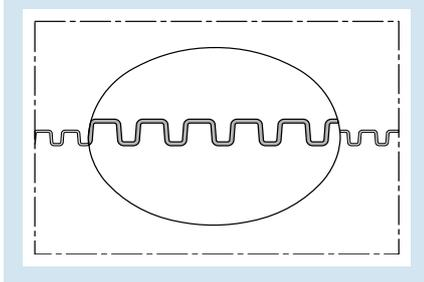
**Parallelgewellter Kunststoff-Schutzschlauch aus modifiziertem PP; hochflexibel und flüssigkeitsdicht**
