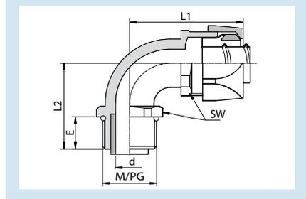
**90° Metall-Schlauchverschraubung mit Innentülle und Dichtung; starres Anschlussgewinde**
