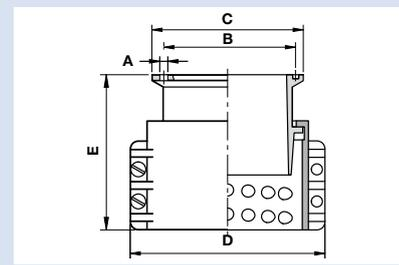
**Extra großer mehrteiliger Kunststoff-Flansch mit Befestigungsbohrungen**
