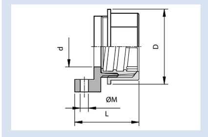
**Mehrteilige Kunststoff-Schlauchverschraubung; starrer Befestigungsflansch**
