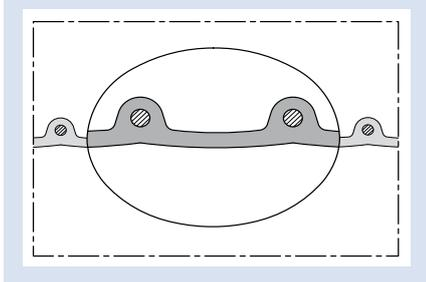
**Extra großer Kunststoff-Schutzschlauch/ Kabelsammler; flüssigkeitsdicht; Spirale: Federstahldraht, fest in die Wandung eingegossen**
